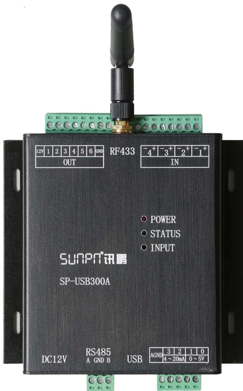
深圳讯鹏科技有限公司自主研发的SP-USB300A工业数据采集器，可通过USB接口轻松实现Windows, Mac, Linux和Android 主机功能扩展，并针对智能制造、智能家居、智慧农场、工业控制、工厂设备等数据的采集与控制做了专业的一体化设计，用户只需通过简单的指令并可采集设备的状态信号、计数信号、4-20mA、0-5V的模拟信号以及输出信号对设备进行相应的控制，并可实现有线到有线，有线到无线等不同设备之间数据交换，从而轻松实现物联网。
